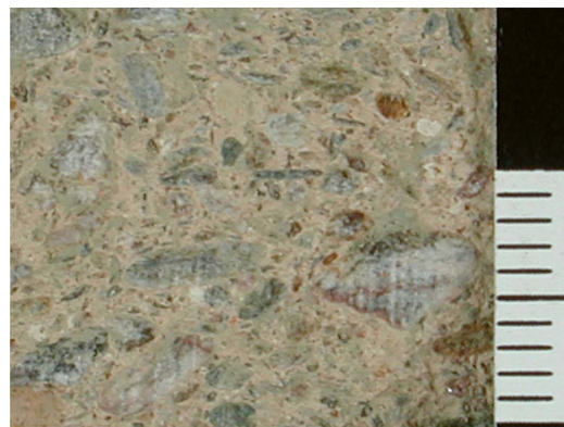
Abb. 20 Gefügebildaufnahme Vergrößerung: siehe Maßstab, 1 Teilstrich = 1 mm
